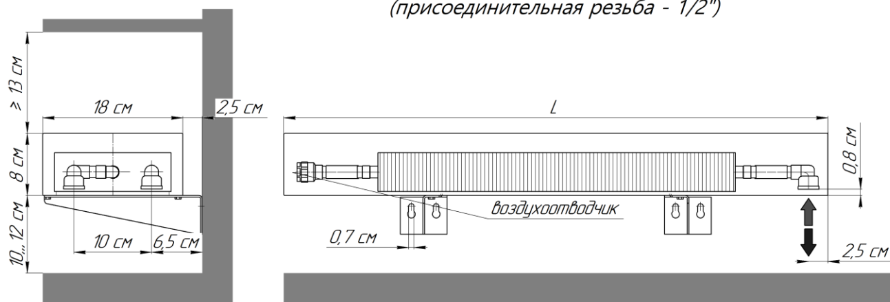
Настенный конвектор "Элегант - мини 180x80-1,5то Стен прав" с правосторонним нижним подключением (левостороннее - зеркально) (присоединительная резьба - 1/2")
